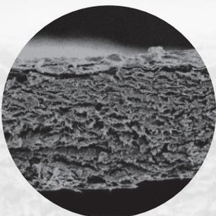
Imagen MEB de Mem-Lok® Pliable con aumento de factor 50 – sin lado específico; capa única densa y uniforme <sup>[19]</sup>
