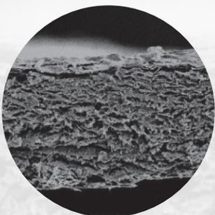
Imagen MEB de Mem-Lok® Pliable con aumento de factor 50 - sin lado específico; capa única densa y uniforme [11]
